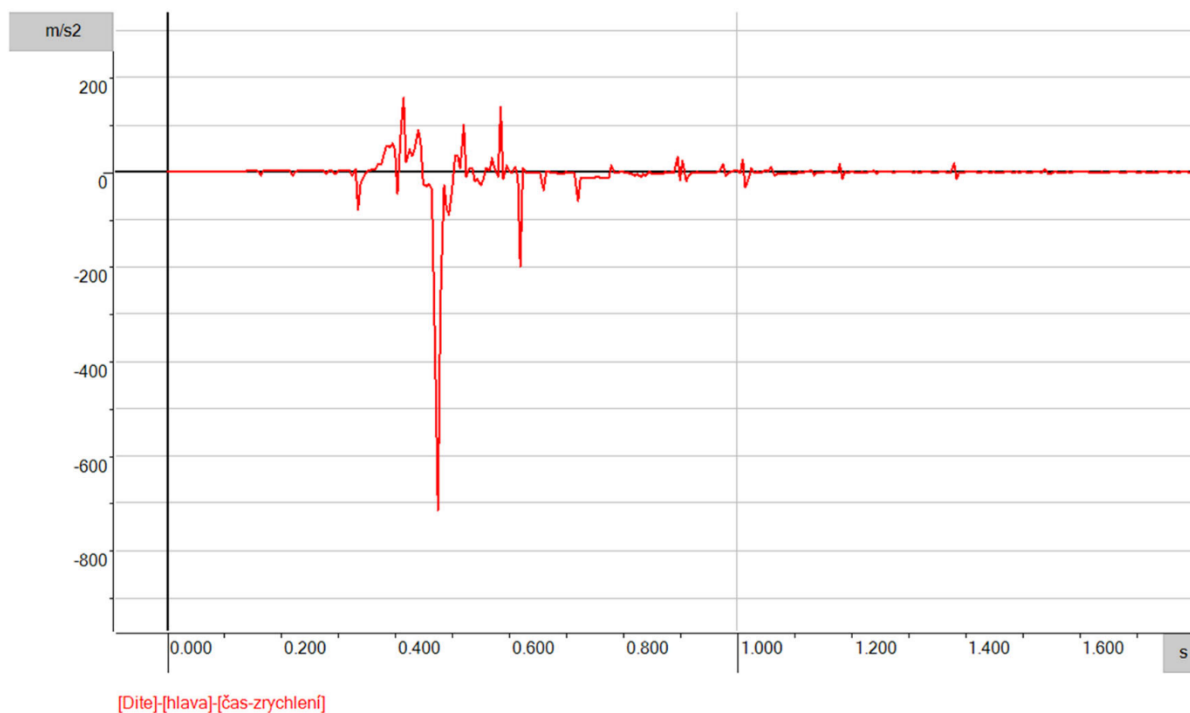
Obrázek č. 40: Graf působícího přetížení na dospělou osobu s dítětem pohybující se na elektrokoloběžce při jejich pádu (simulace Simulace_pad_dosp_dite); dítě – hlava
