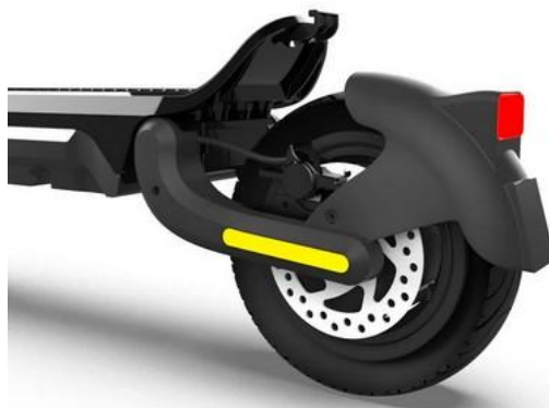
Obrázek č. 29: Umístění zadní odrazky červené barvy na elektrické koloběžce
